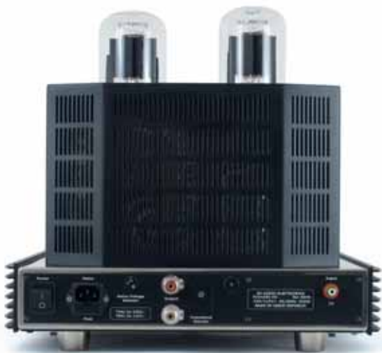
Il pannello posteriore, minimalista al punto che la selezione dell'impendenza avviene smontando uno sportellino posto accanto ai morsetti.
