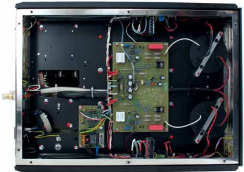
Cablaggio parzialmente in aria, nella migliore delle tradizioni degli ampli a valvole.
